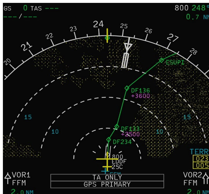
Terrain: Hintergrunddarstellung aus EGPWS Datenbank, Geländefärbung abhängig von Flugzeughöhe
