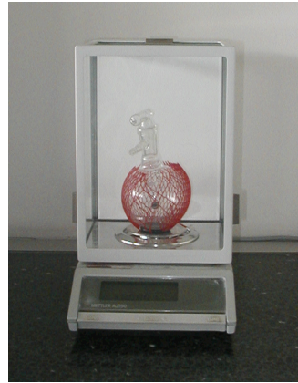
Wiegen des Glaskolbens vor/nach Evakuierung: m
