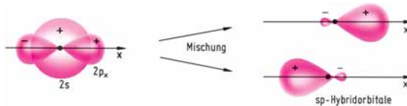
Abbildung 2.38 Schematische Darstellung der Bildung von sp-Hybridorbitalen. Aus einem 2s- und einem 2p_x -Orbital entstehen zwei sp-Hybridorbitale. Die sp-Hybridorbitale bilden miteinander einen Winkel von 180^\circ .
