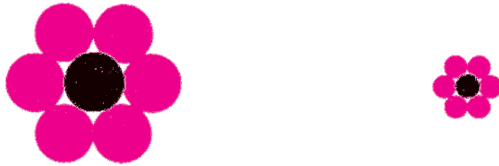
Abbildung 2.14 Die Koordinationszahl eines Kations hängt vom Größenverhältnis Kation/Anion ab, nicht von der Absolutgröße der Ionen. Ist der Radienquotient r_K/r_A = 1 , lassen sich in einer Ebene gerade sechs Anionen um ein Kation packen.
